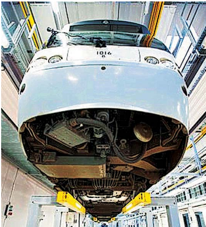
Das Stadtbahn-Fahrzeug wird für die Wartungsarbeiten angehoben.
