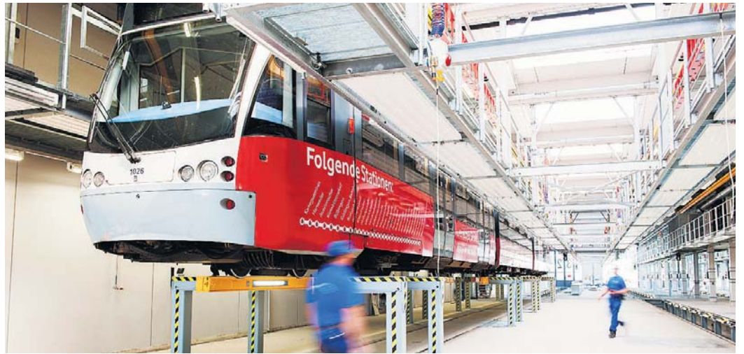
Ein Stadtbahn-Mitarbeiter bei der Reparatur eines Kupplungssteckers (links). Rechts die ausgefahrne Unterflurhebeanlage: Das Fahrzeug steht auf Drehgestellhebern.
