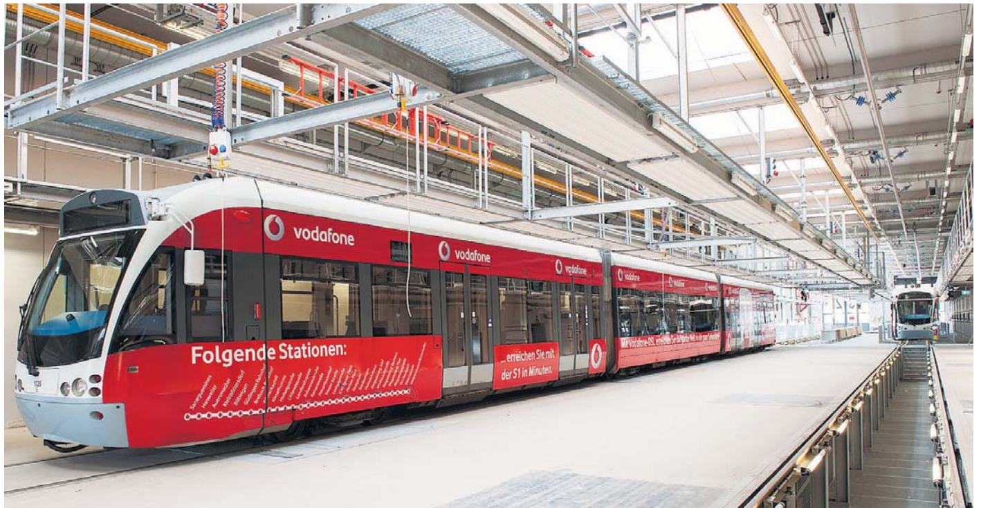
Die Stadtbahn-Fahrzeuge sind sogenannte Zweisystem-Züge. Sie werden in Wien vorgefertigt und im belgischen Brügge endmontiert.
