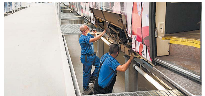
Ein Stadtbahn-Mitarbeiter bei der Reparatur eines Kupplungssteckers (links). Rechts die ausgefahrne Unterflurhebeanlage: Das Fahrzeug steht auf Drehgestellhebern.
