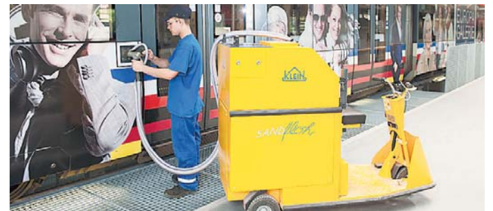
Oben: Ein Arbeitsstand mit Arbeitsgrube. Die seitlichen Roste können bei Bedarf aufgeklappt werden. Unten: Ein Stadtbahn-Mitarbeiter beim Betanken des Stadtbahn-Fahrzeugs mit Brems sand.
