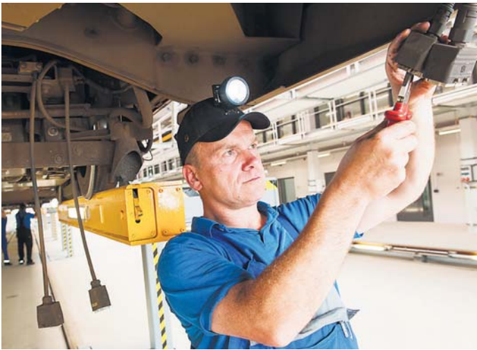
Ein Stadtbahn-Mitarbeiter bei der Reparatur eines Kupplungssteckers (links). Rechts die ausgefahrne Unterflurhebeanlage: Das Fahrzeug steht auf Drehgestellhebern.
